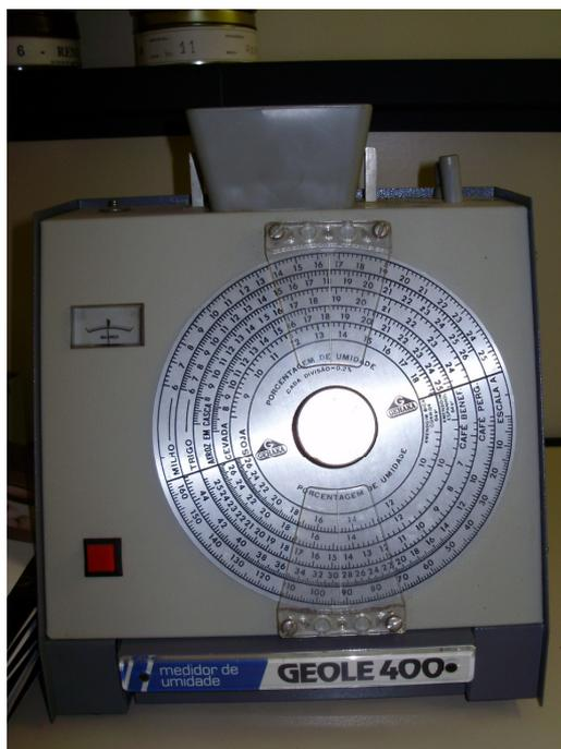
**Figura 3.** Medidor de Umidade marca Geole 400
