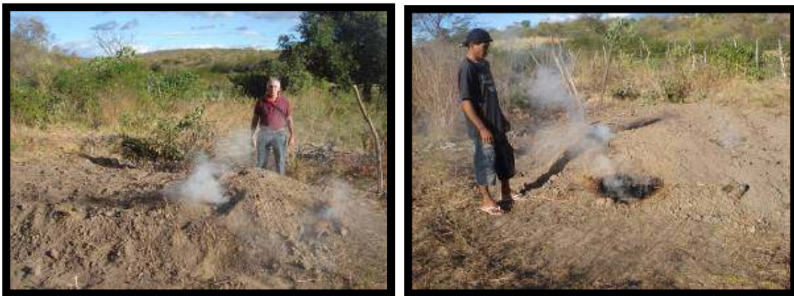
Figura 23 – Carvoeira ou bacural, vala escavada no solo, utilizada para a fabricação de carvão vegetal. Assentamento Santana em Iguatu-CE (20/10/2009).
