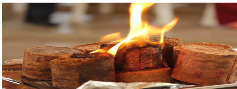
Figura 43 – Lenha ecológica (pesquisa desenvolvida no CNP) à base de serragem, palha de arroz ou outro resíduo misturado a uma resina vegetal para formação do briquete Fonte: Autor da dissertação, 2018
