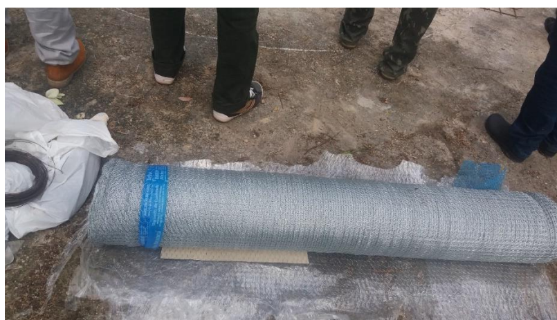
Figura 26 – Tela de galinheiro que se prende a tela de ferro Fonte: Próprio autor
