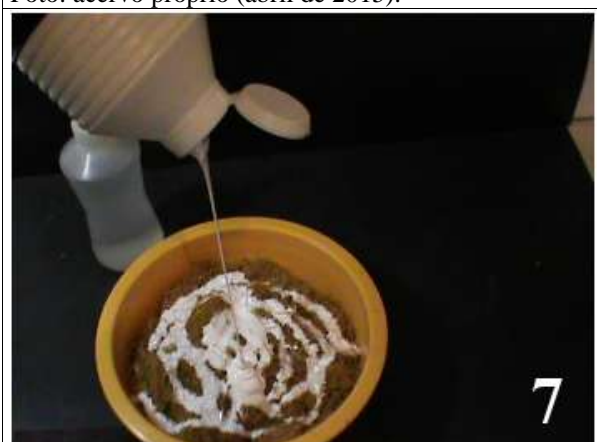
Figura 34. Adicionar o aglomerante adequado às fibras. Foto: acervo próprio (abril de 2015).
