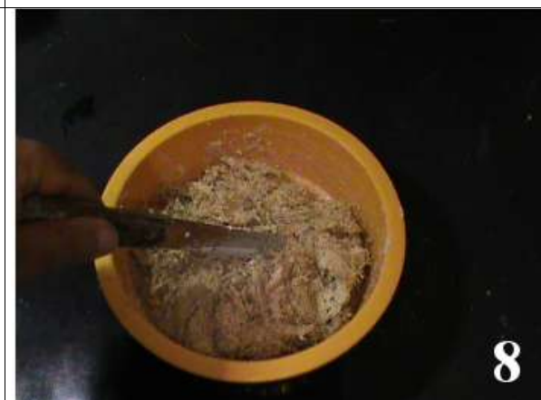
Figura 35. Homogeneizar as fibras e o aglomerante e acondicioná-las em sacos plásticos até o uso. Foto: acervo próprio (abril de 2015).
