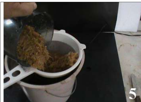
Figura 32. Separar as fibras da água utilizando uma peneira. Foto: acervo próprio (abril de 2015).
