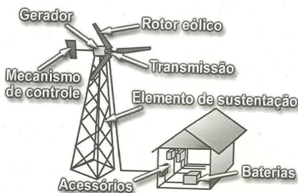
Figura 8 - Sistema eólico para geração de energia elétrica. Fonte: Da própria pesquisa.
