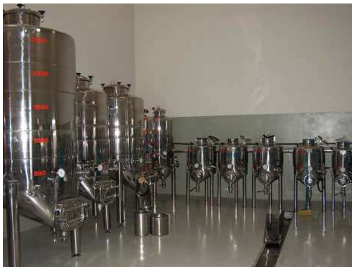
Foto 4. Dornas de fermentação da planta de processamento de vinho do IFSertão-PE. Fonte: Genai, 2012
