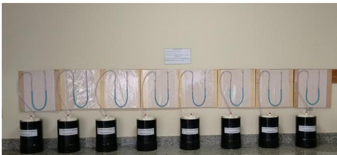
Figura 5. Detalhe dos protótipos dos biodigestores construídos para o experimento.
