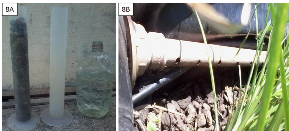
Figura 8. A: provetas utilizadas para medição do índice de vazios do material filtrante. B: tubo de alimentação do SAC com seus respectivos orifícios de distribuição.
