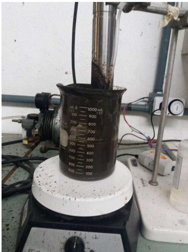
**Figura 11** – Aparato utilizado para a realização dos ensaios respirométricos
