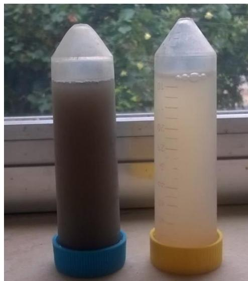
**Figura 11.** À esquerda a água residuária da suinocultura (ARS) afluente ao filtro orgânico preenchido com bagaço de cana-de-açúcar e à direita o efluente após 36 L de ARS filtrado.
