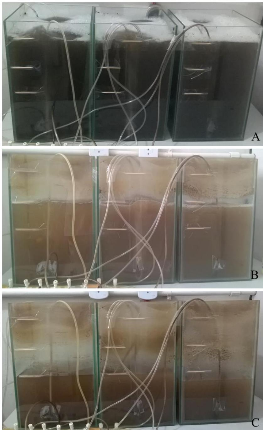
**Figura 16.** Redução do volume e alteração da cor da água residuária da suinocultura durante os trinta e dois dias de digestão aeróbia. No início do processo de digestão aeróbia, com coloração preta (A), após 12 dias (B) e 23 dias (C) de tratamento.
