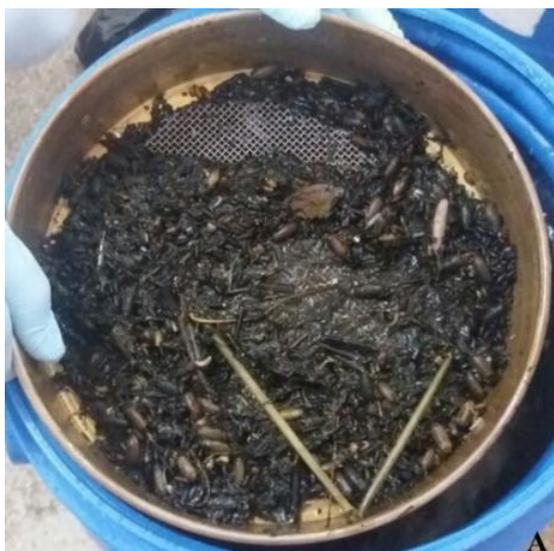
**Figura 5.** Tratamento preliminar da ARS. Detalhe dos sólidos grosseiros contidos na água residuária da suinocultura e retidos na peneira de 2 mm de diâmetro.
