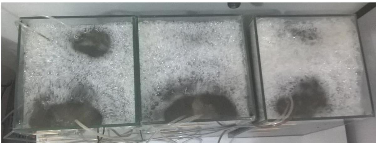
**Figura 14.** Formação de espuma na água residuária da suinocultura quando submetida à aeração.
