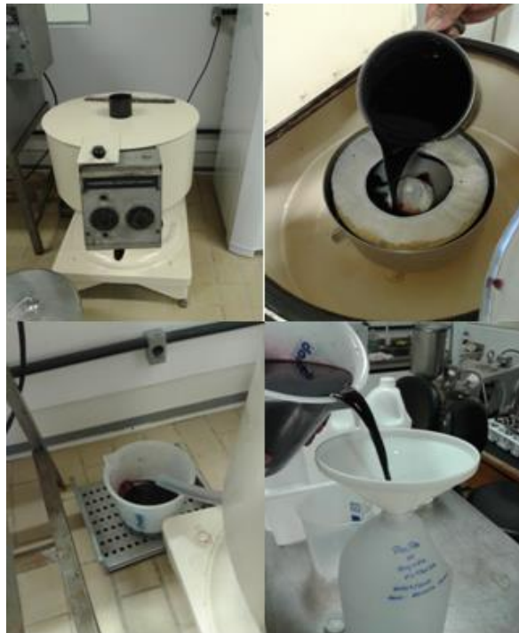
Figura 4 – Processo de centrifugação da polpa integral de juçara.
