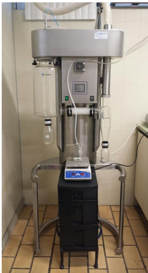
Figura 5 - Mini spray dryer LabPlant SD-06 (Huddersfield, Reino Unido)
