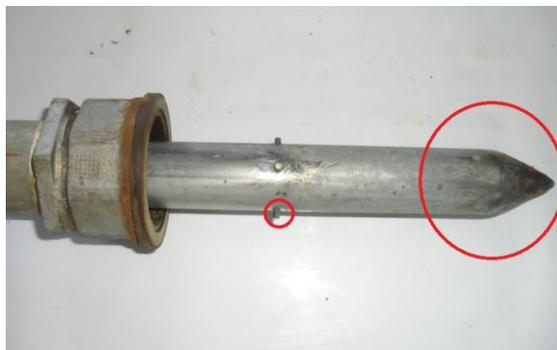
**Figura 21:** Foto demonstrativa da centralização do anular com destaque nos espaçadores e na ponta do tubo interno.
