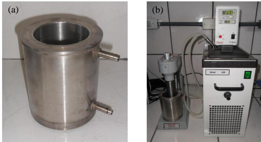
**Figura 28:** (a) Copo encamisado utilizado em ensaio reológico e (b) Conjunto banho termostático, viscosímetro FANN 35A e copo encamisado
