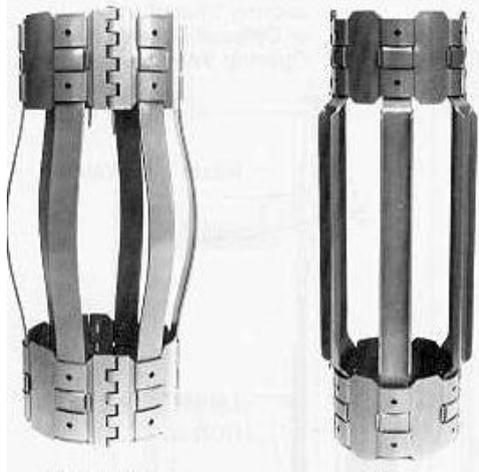
**Figura 8:** Centralizadores, adaptado de CAMPOS *et al.* (2002).
