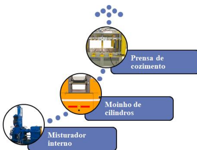
Figura 24 – Esquema de produção dos compostos de borracha.
