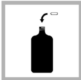
**1.** Coloque uma barra de agitação BODTrak II no recipiente.
