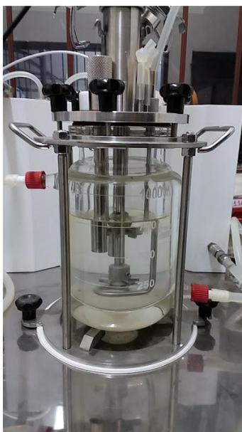
**Figura 9.** Módulo de vaso de reação do equipamento.
