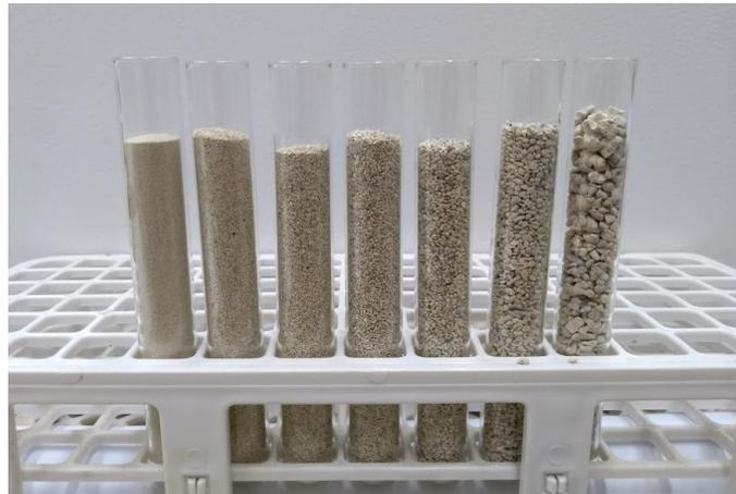
**Figura 21.** Amostras do granulado bioclástico em diferentes faixas granulométricas.
