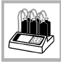
4. Coloque os recipientes na base BODTrak II. Conecte o tubo aplicável ao recipiente de amostra e aperte a tampa.
