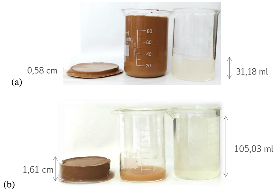
Figura 68. Comparação entre espessura, fluido remanescente e volume de filtrado nos experimentos (a) sem sedimentação e (b) com sedimentação prévia de sete dias. Fonte: autoria própria.
