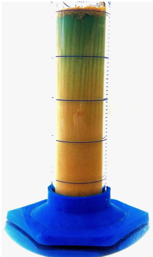
Figura 53. Encadeamento de partículas visualizado em proveta de 50 mL. Fonte: autoria própria.
