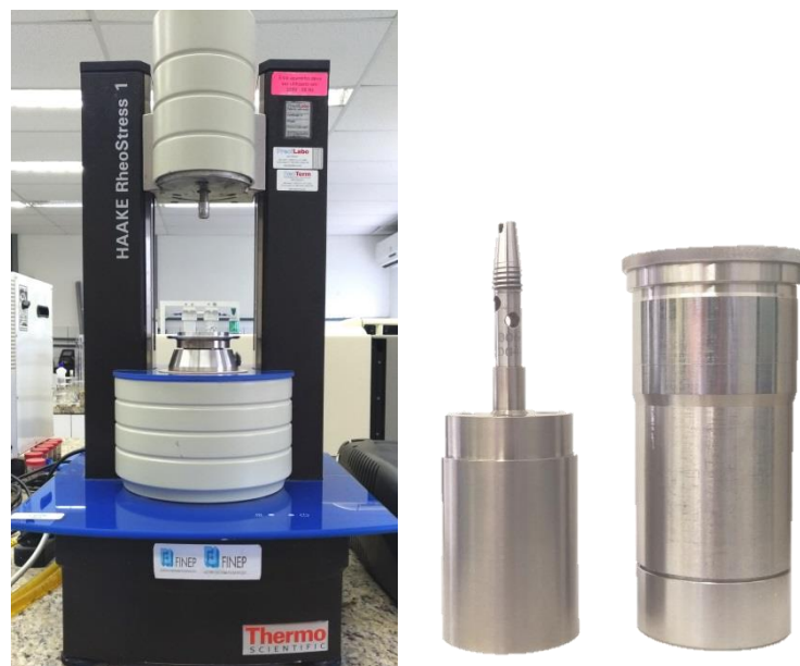
Figura 38. (a) Reômetro Haake RheoStress 1; (b) geometria de cilindros coaxiais.
