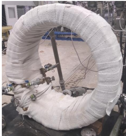
Figura 36. Foto da bobina isolada termicamente.
