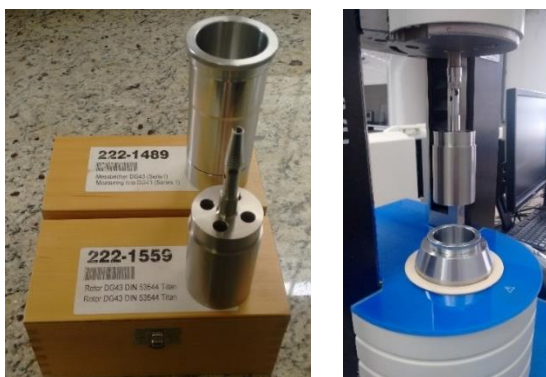
Figura 34. Geometria de cilindros coaxiais DG43-Ti.
