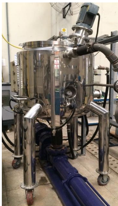
Figura 24. Tanque com agitador.
