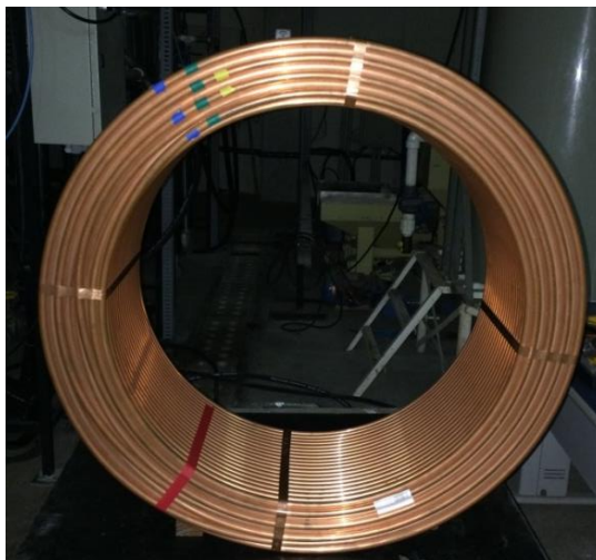
Figura 19. Foto da bobina de tubo de cobre representando o coiled tubing numa escala piloto.
