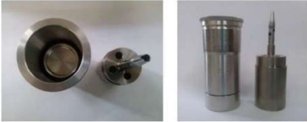
Figura 22. Geometria de cilindros coaxiais (Fonte: Carvalho, 2017).
