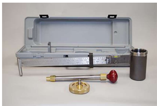
Figura 19. Balança de lama pressurizada (Fonte: Handom, 2017).
