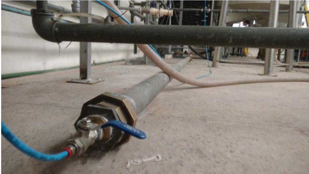
Figura 35 – Tubo-reservatório de volume conhecido (6,5 litros). Fonte: O autor.
