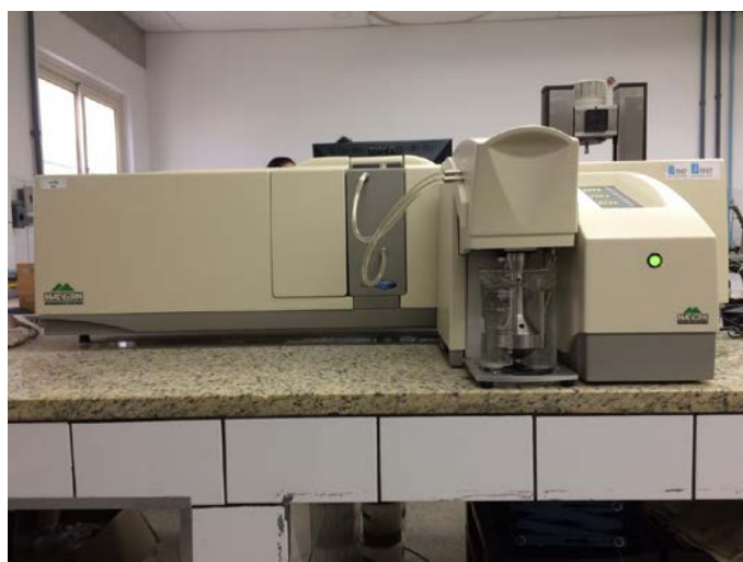
Figura 9 - Analisador de partículas Mastersizer 2000 da Malvern Instruments
