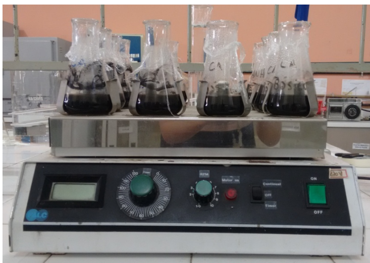
Figura 15 - Amostra de carvão ativado em contato com as soluções ácidas e básicas sob agitação
