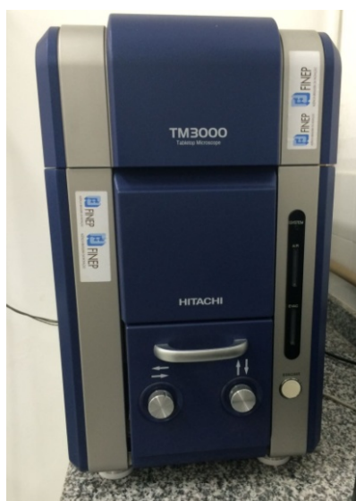
Figura 13 - Microscópio Eletrônico de varredura TM 3000, HITACHI
