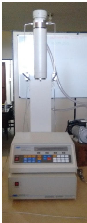
Figura 7 - Bomba Seringa Modelo 500D utilizado nos teste de dessorção
