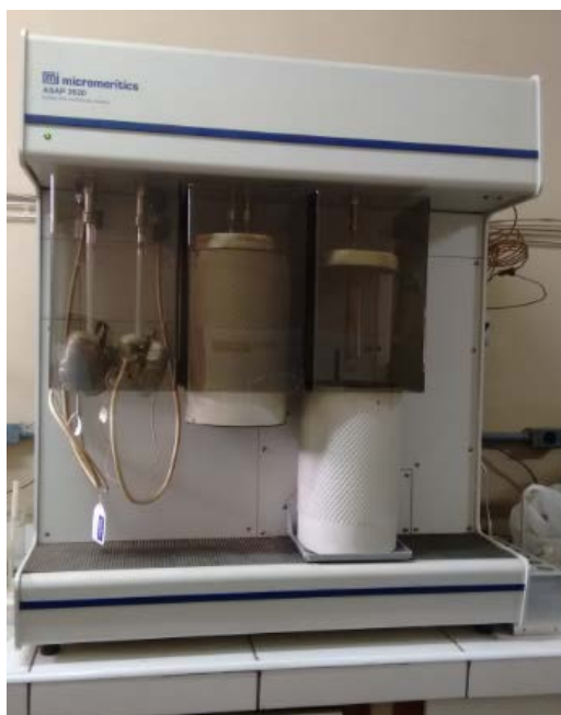
Figura 11 - Equipamento ASAP 2020, marca Micromeritics
