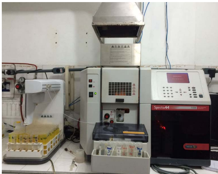
Figura 14 - Espectrômetro de absorção atômica SPECTRAA 55B, Varian
