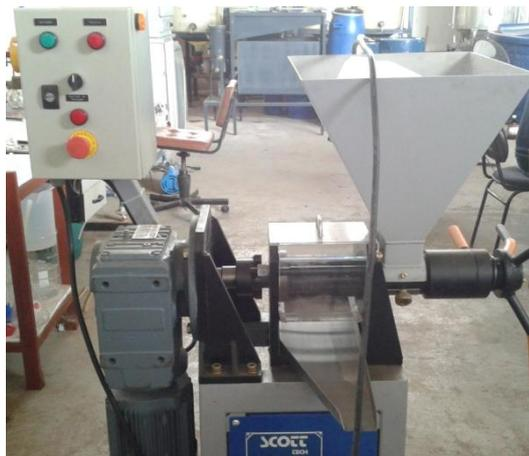
Figura 12 – Foto da prensa (SCOTT TECH ERT6011 NS 186-8) utilizada na prensagem das sementes de pinhão-mansão
