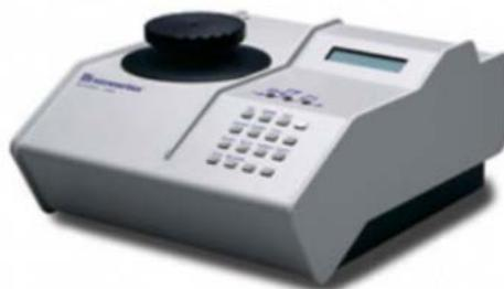
**Figura 3.1:** Picnômetro a gás hélio AccuPyc 1330.
