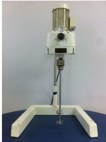
**Figura 3.5:** Agitador mecânico modelo 722 da Fisatom.
