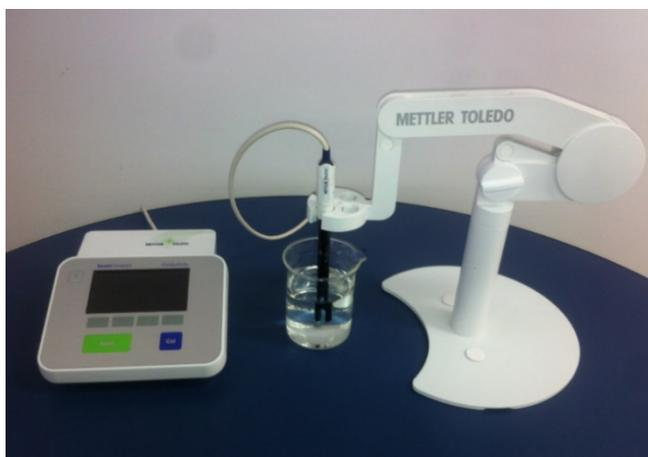
**Figura 3.7:** Condutivímetro SevenCompact e eletrodo da série InLab 73X utilizados nos ensaios de sedimentação.
