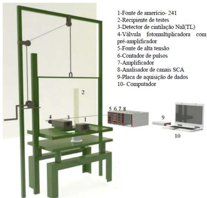
Figura 2.11: Ilustração da unidade de aplicação de radioisótopos (FAGUNDES, 2015).
