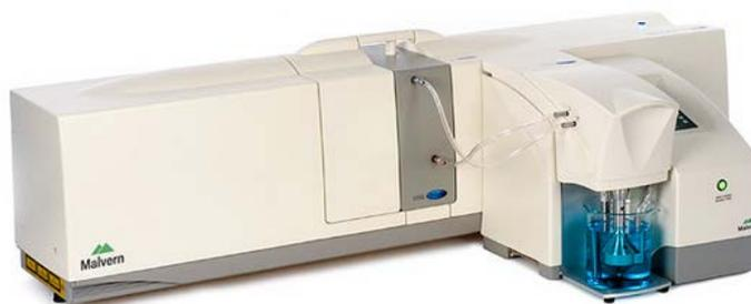
**Figura 3.2:** Analisador de tamanho de partículas Malvern Mastersizer 2000.
