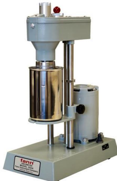
Figura 21 - Viscosímetro rotacional
