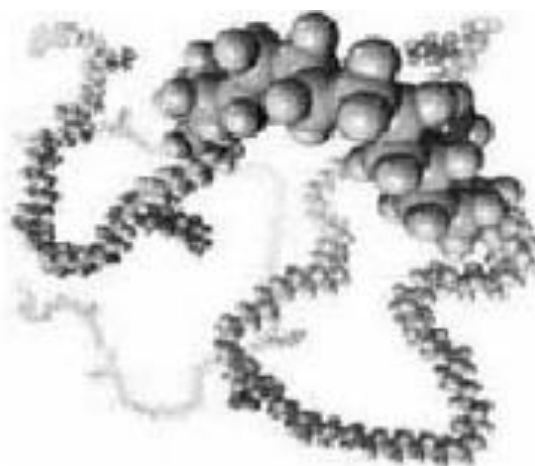
Figura 1- Representação esquemática da estrutura do PEBD (COUTINHO et al. , 2003)
