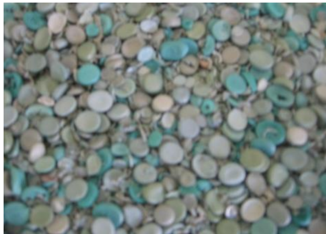
Figura 3 - Aspecto do polietileno (PEBDrec) na forma de pellets.
