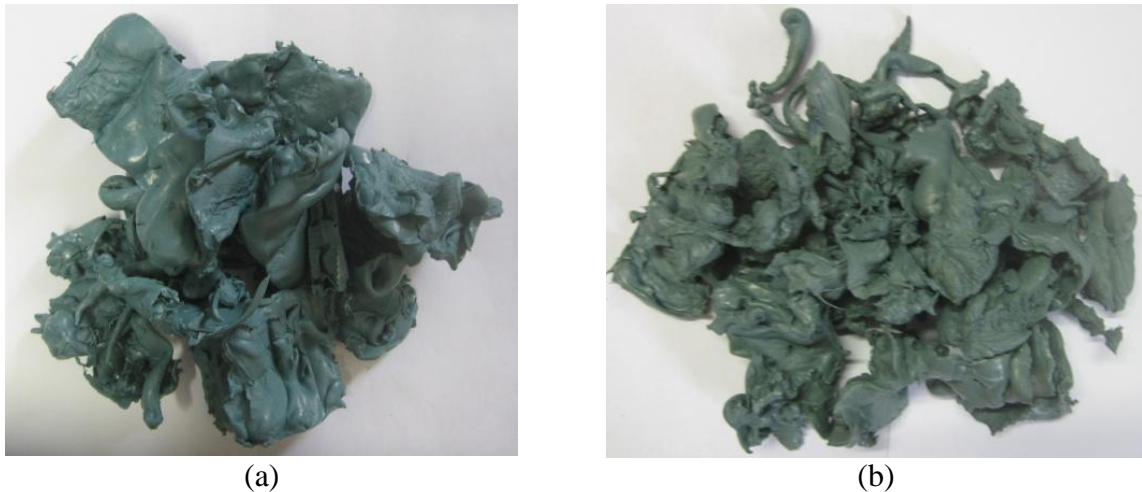
Figura 11- (a) Aspecto dos compósitos produzidos com PEBDrec modificado por H_2O_2 , (b) aspecto dos compósitos produzidos com PEBDrec modificado por KMnO_4 .
