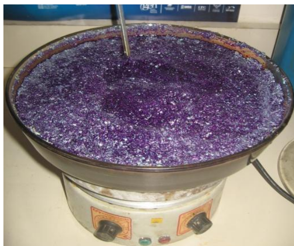
Figura 8 – PEBDrec sendo tratado quimicamente com KMnO 4 á 45°C.
