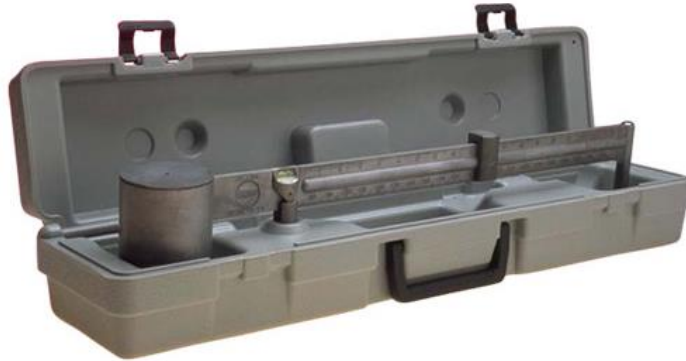
Figura 47 - Foto ilustrativa do FANN Balança de Lama no qual foram determinadas as densidades dos fluidos para teste de bancada (Fonte: www.eurosul.com , acessado em 27/10/2016).
