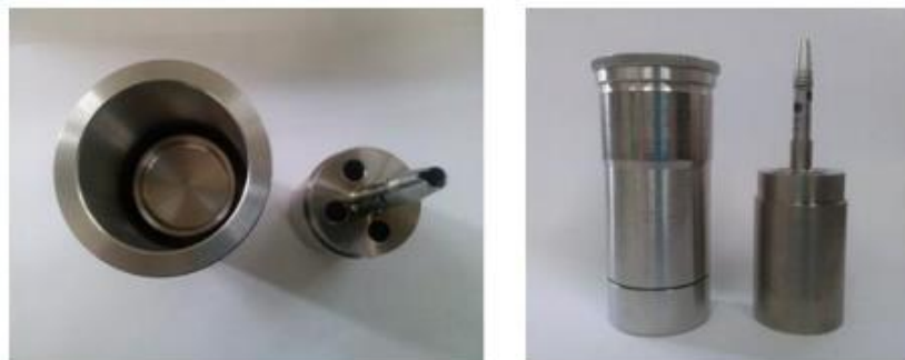
Figura 43 - Foto da geometria de cilindros coaxiais do equipamento Haake Rheostress 1 (Fonte: Imagem pessoal, 2016).
