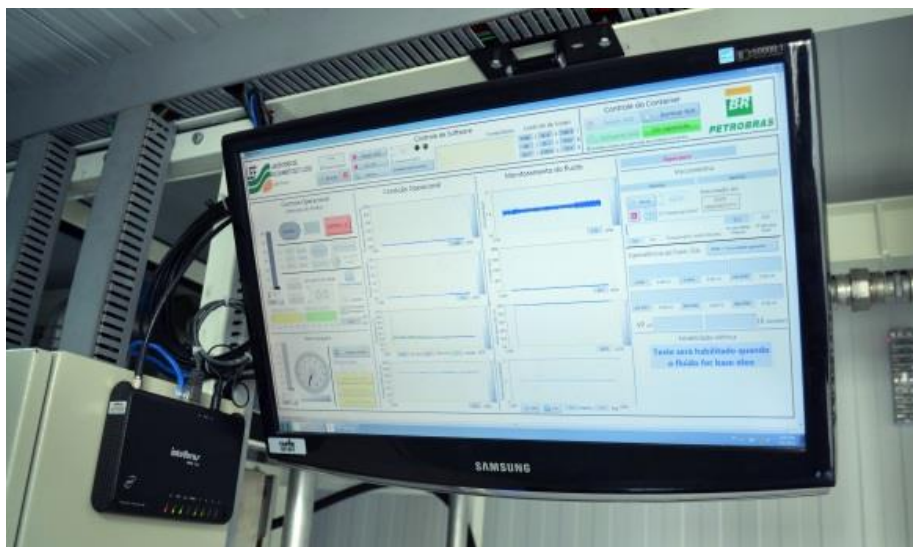
Figura 35 - Foto da interface homem-máquina onde é capaz de realizar leituras das propriedades em tempo real (Fonte: Imagem pessoal, 2016).
