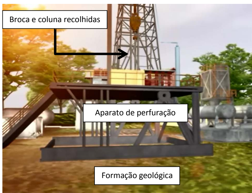
Figura 1. Esquema de um sistema de perfuração (perfuratriz). Fonte: acervo pessoal do autor, adaptado de Halliburton INC.
