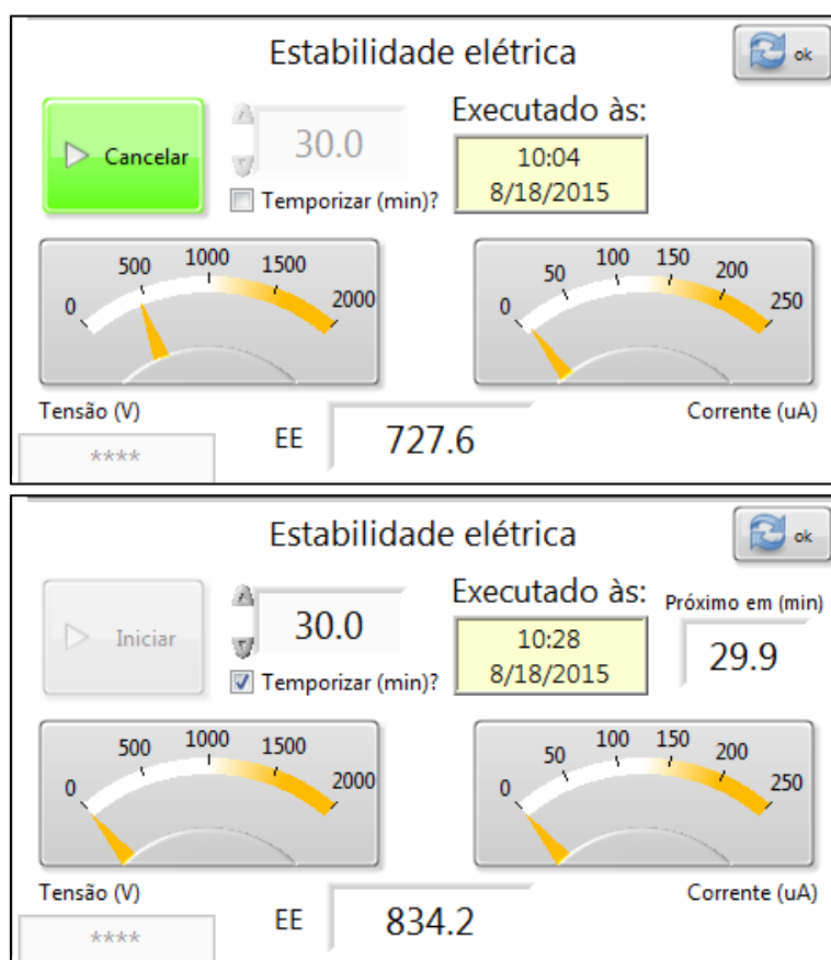
Figura 99. Zoom na IHM da “Estabilidade Elétrica” e funcionamento.
