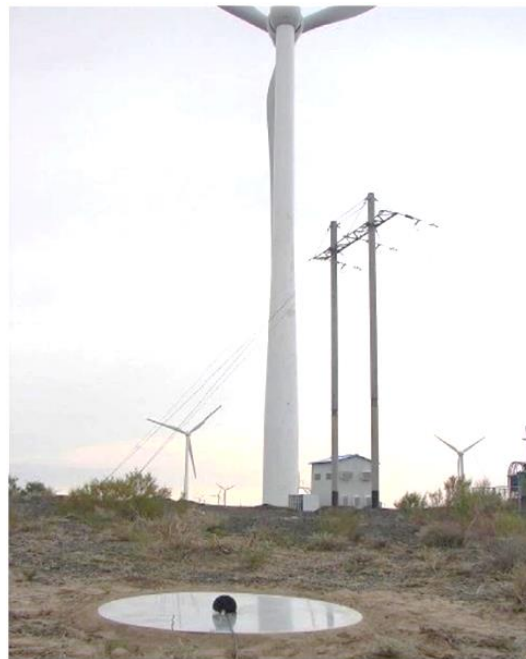
Figura 48. Sistema a ser monitorado: ruídos da turbina eólica próxima a residências. Adaptado de Lin et al. (2010).
