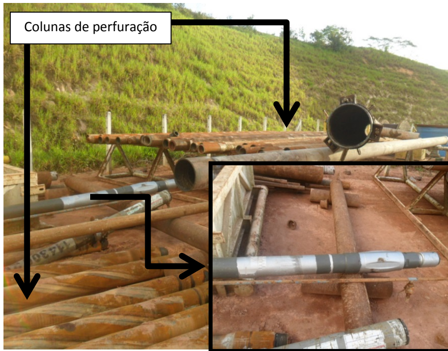
Figura 9. Colunas de perfuração e detalhe no estabilizador, componente que precede a broca de perfuração. Fonte: Acervo pessoal do autor.
