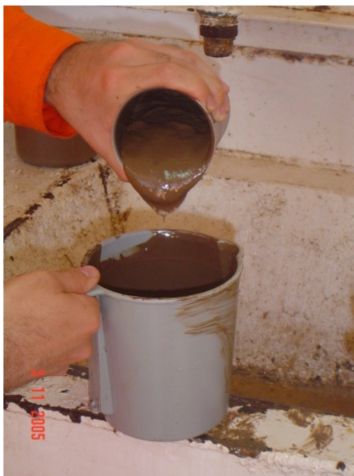
Figura 11. Amostra de fluido de perfuração. Fonte: Acervo pessoal do autor, adaptado de autor desconhecido.
