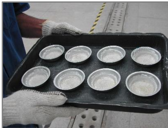
Figura 33 – Formas de alumínio e resíduos de sal após tratamento em estufa (método gravimétrico).
