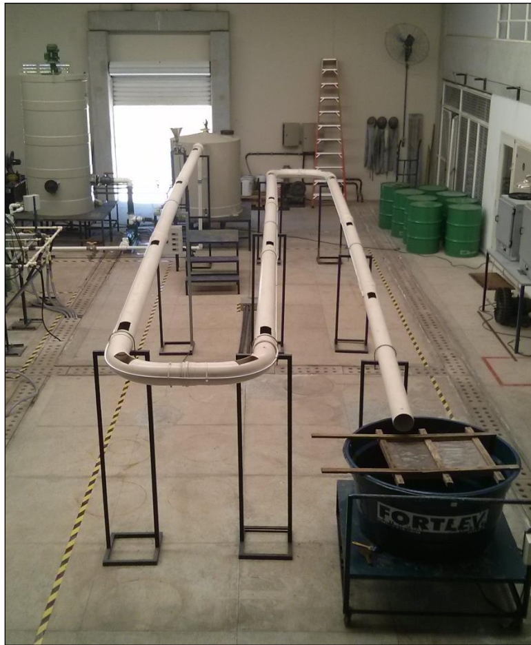
Figura 20 - Foto da unidade experimental de escoamento de sais vista superior.
