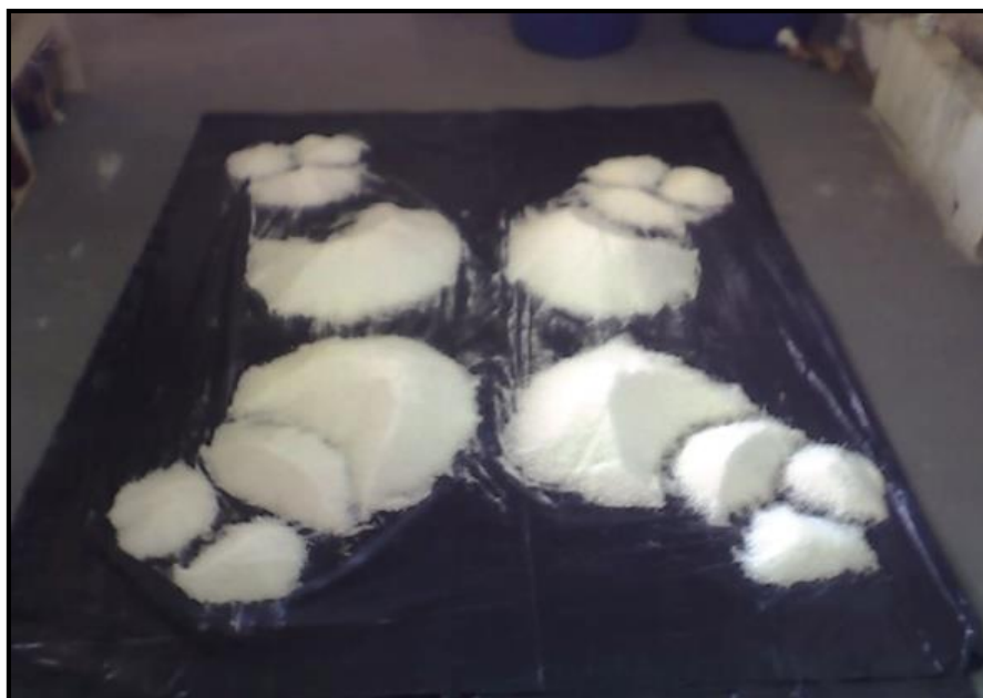
Figura 27 - Foto da aplicação da técnica de quartejamento.
