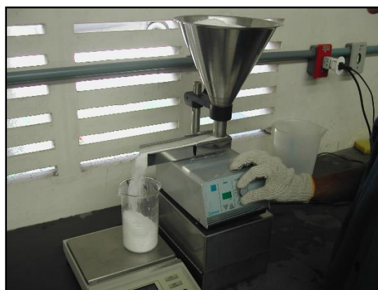
Figura 22 – Representação da calibração do laboreto.
