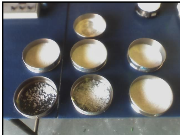
Figura 30 – Separação por serie de peneiras para análise granulométrica das amostras.
