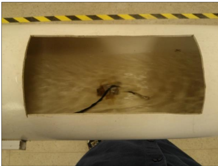
Figura 24 - Foto da extremidade interna da tomada de concentração.
