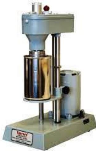
**Figura 29.** Viscosímetro Fann 35A. Fonte: Catálogo Fann.
