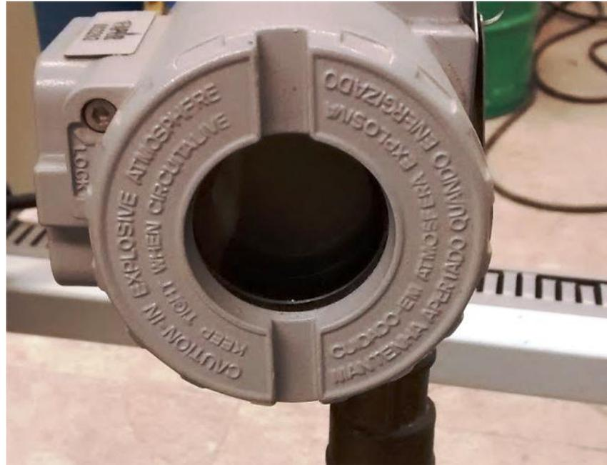
**Figura 33.** Transmissor de temperatura Smar TT 301.
