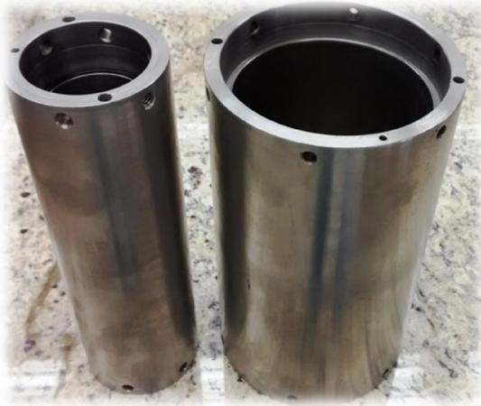
**Figura 23.** Cilindros da célula de bancada *HHP*.
