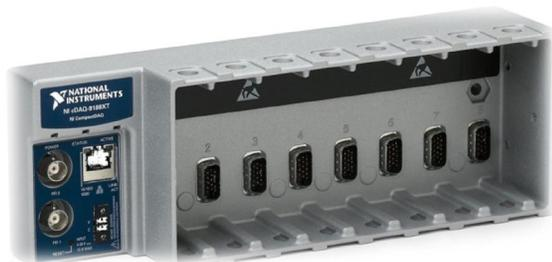
**Figura 36.** Chassi de placa de aquisição de dados National Instruments.
