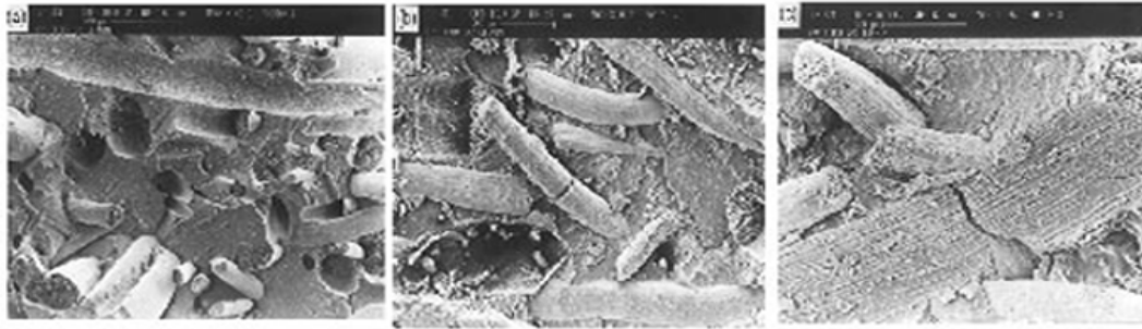
Figura 6 – (a) MEV dos compósitos com 30% de fibra sem lignina; (b) MEV dos compósitos com 30% de fibra e 10% de lignina; (c) MEV dos compósitos 30% de fibra e 20% de lignina (ROZMAN et al. , 2000)
