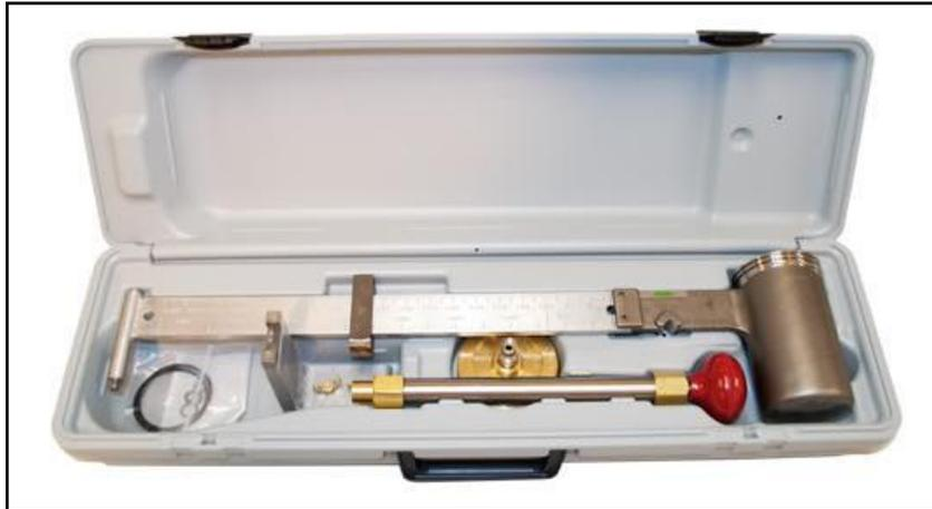
**Figura 15.** Balança de lama Fann modelo 140. Fonte: Fann (2016).
