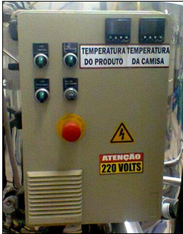
**Figura 8.** Painel de controle acoplado ao tanque.
