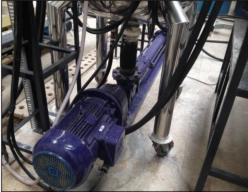
**Figura 4.** Bomba helicoidal de deslocamento positivo.
