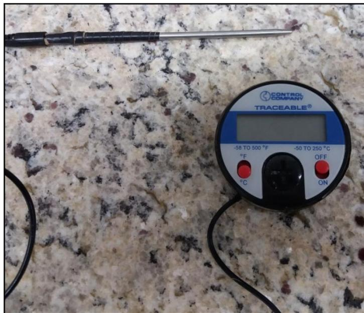
**Figura 16.** Termômetro portátil Traceable®.
