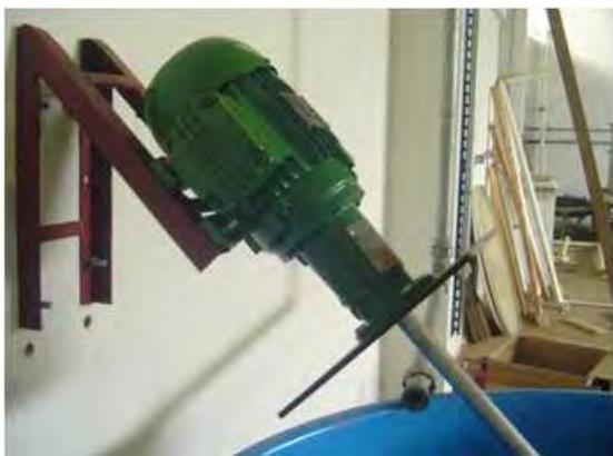
**Figura 3.3** - Agitador mecânico rápido de 1,5 cv.
