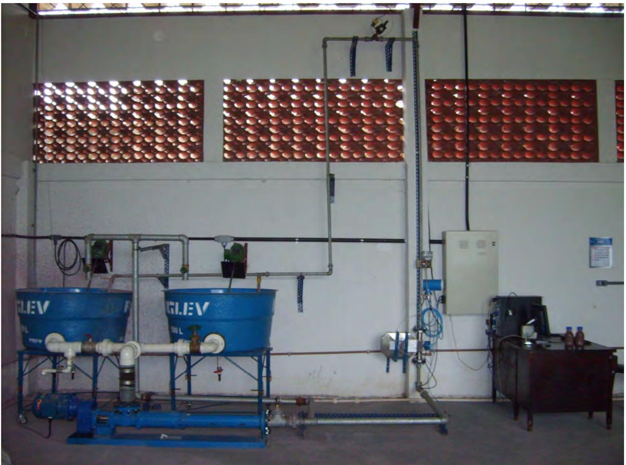
**Figura 3.10** - Unidade experimental para o controle de pressão anular.
