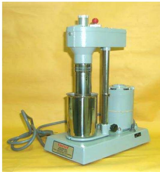
**Figura 3.15** - Viscosímetro FANN V. G. Metter modelo 35 A.
