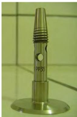
**Figura 3.17** - Sensor placa-placa.
