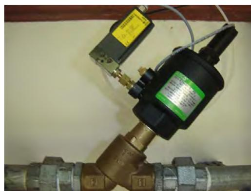
Figura 3 - Válvula de controle para simular a válvula de *choke*.
