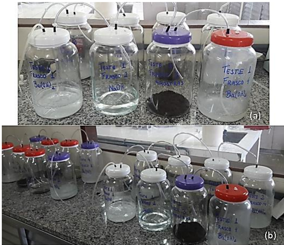
Figura 18. Foto dos (a) frascos que compõem o sistema para 1 dos testes de respirometria; (b) os 4 conjuntos completos (Fonte: Adaptado de ROSA et al., 2002; COELHO et al., 2008; NEVES & PIRES, 2011; TAIATELE JUNIOR, 2014).
