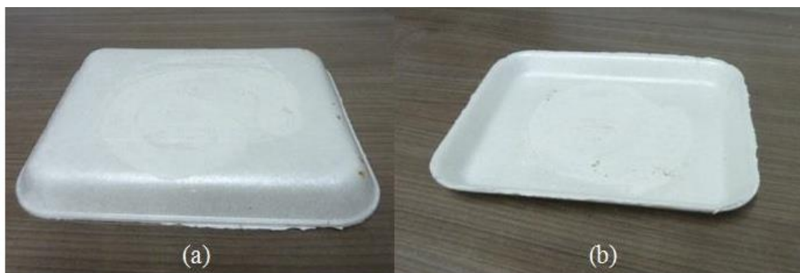
Figura 10. Embalagem à base de amido de mandioca: (a) vista externa da embalagem; (b) vista interna da embalagem (SOUZA et al., 2012; ONOFRE et al., 2016).
