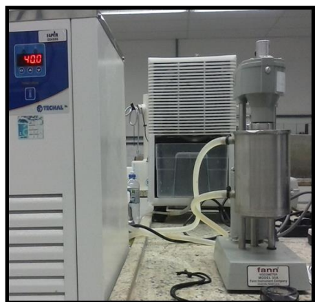
Figura 17: Viscosímetro FANN35 A com o copo termostatzado a 40 °C.
