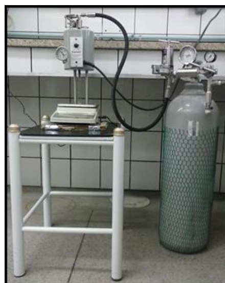
Figura 20: Cilindro de Nitrogênio acoplado à célula de filtração HPHT.
