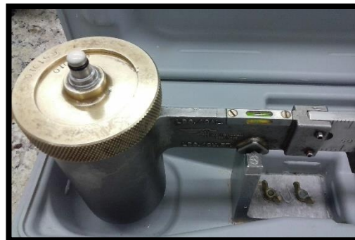
Figura 14: Ilustração da aferição da densidade do fluido na balança de lama.
