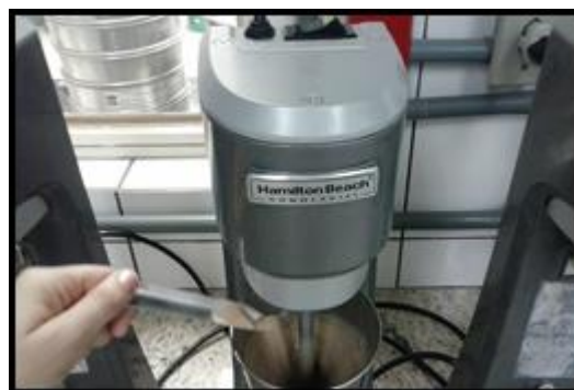
Figura 12: Procedimento de adição de sólidos no copo do agitador mecânico.
