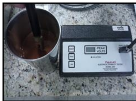
Figura 16: Medição da estabilidade elétrica de um fluido de base olefínica.
