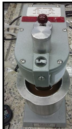
Figura 18: Visão superior do viscosímetro FANN 35 A durante um ensaio.
