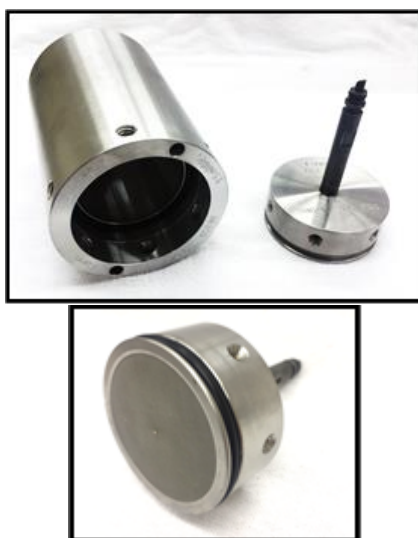
Figura 19: Detalhes da célula HPHT e da tampa com a peneira acoplada.
