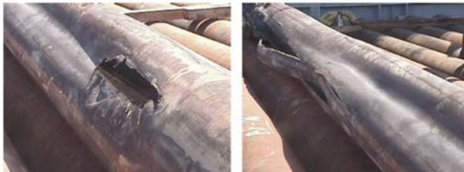
Figura 1. Revestimento de 16” colapsado no poço Pompano A-31. Fonte: Patillo et al. (2004).
