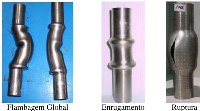
Figura 5. Diferenças entre Flambagem Global, Enrugamento e Ruptura. Fonte: Abrantes (2009).
