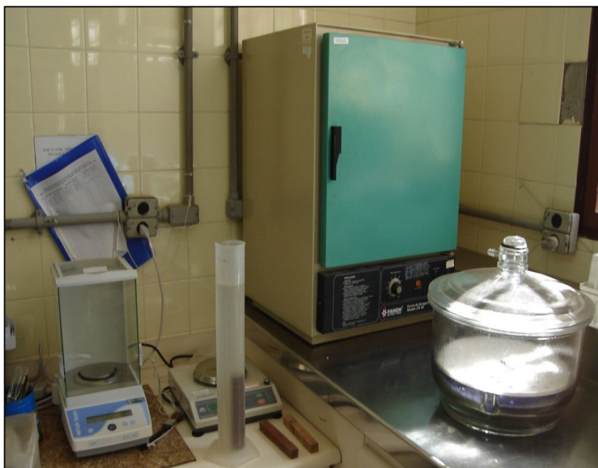
Figura 7 - Esquema de imersão da estacas para determinação da densidade da madeira.
