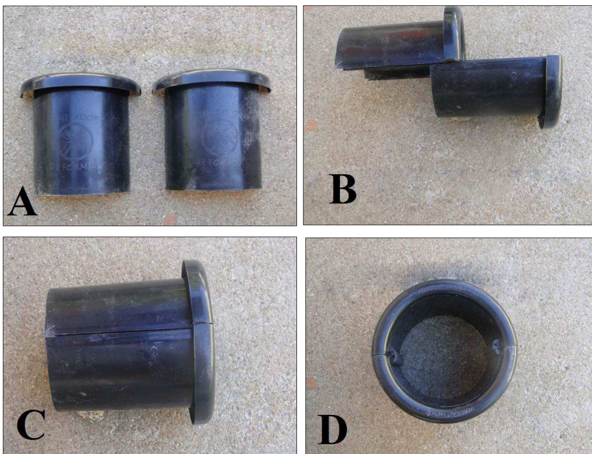
Figura 4. Barreira comercial cilíndrica anti-formigas avaliada: A) Vista da barreira aberta; B) Vista do encaixe das duas bandas; C) Vista das duas metades da barreira comercial encaixadas; e D) Vista superior da barreira física comercial montada para uso.
