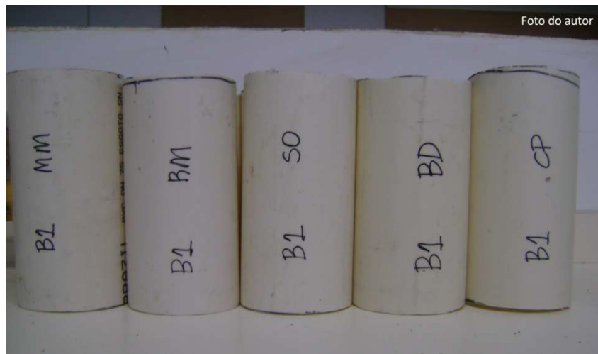
Figura 08: Tubos de PVC com tratamentos identificados por códigos para favorecer o reconhecimento do tipo de corpo-de-prova após retirada em campo. B1= refere-se ao local 1 (Bloco 1). Tratamentos: MM=maniva de mandioca ( Manihot esculenta ); RM=raiz de mandioca ( Manihot esculenta ); SO= tolete de cana-de-açúcar ( Saccharum officinarum ); BD= raiz de batata-doce ( Ipomea batatas ); CP= caule do mamoeiro ( Carica papaya ). Seropédica, RJ, 2014.
