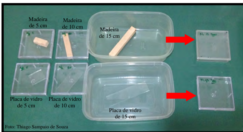
Figura 8. Esquema da retirada da madeira de Eucalyptus grandis de 5 e 10 cm e suas respectivas placas de vidro depositadas em caixas gerbox, e a madeira de 15 cm e sua respectiva placa de vidro alocadas primeiramente em potes plásticos e, em seguida, os térmitas coletados foram transferidos para caixas gerbox.
