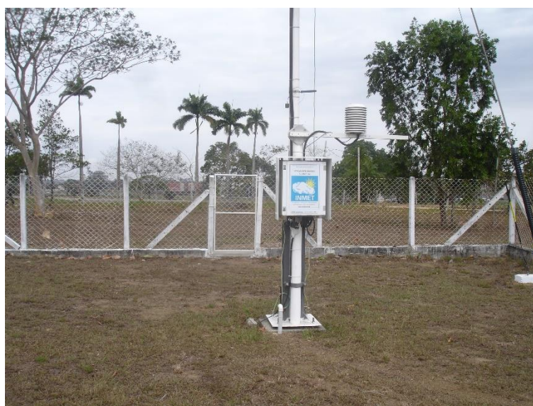
Figura 3. Caixa de chapas de aço para proteção do subsistema de armazenamento de dados data-logger. Fonte: Tamires Medeiros
