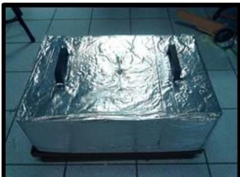
**Figura 10.** Câmara estática fechada, composta de base e tampa utilizada no experimento. Percebe-se o detalhe do revestimento da tampa com espuma e manta aluminizada para evitar o aquecimento interno pela incidência de raios solares.
