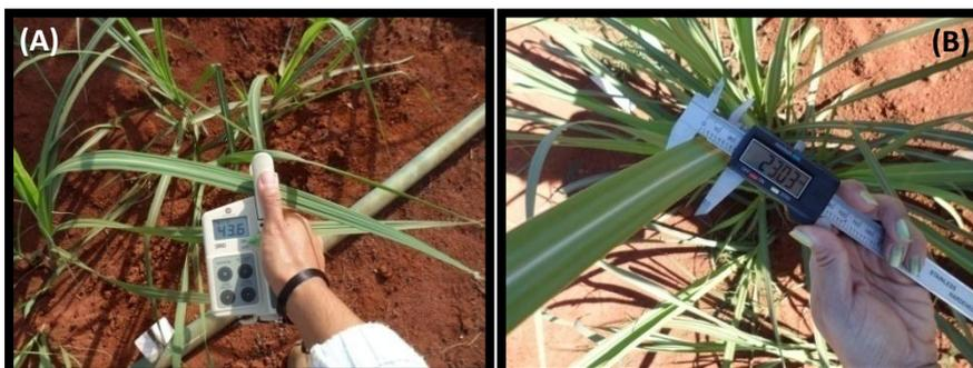
**Figura 11.** Equipamentos utilizados para análise do desenvolvimento da cultura. (A) SPAD, para medir a porcentagem (%) de clorofila nas folhas; (B) Paquímetro, para medir o diâmetro foliar e do colmo (mm).
