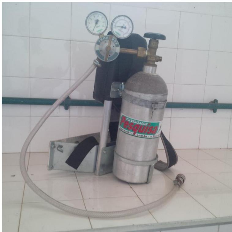
**Foto 2.** Pulverizador costal pressurizado por CO<sub>2</sub>
