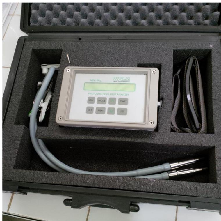
**Foto 3** Fluorímetro analizador de rendimento da fotossíntese MINI-PAM.
