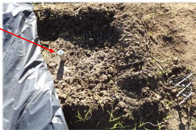
Figura 15: Bacia de calibração (em detalhe sonda Hidrofarm).
