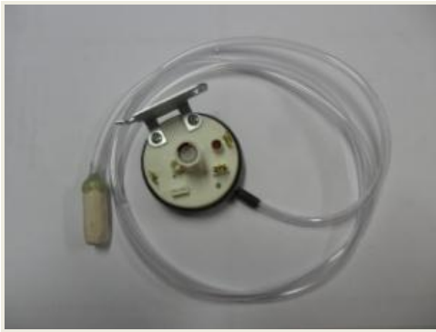
Figura 3. Acionador simplificado para irrigação
