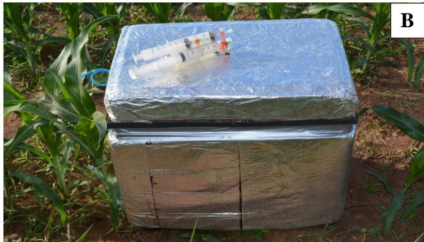
Figura 1. Base metálica e câmara para coleta de N_2O (A); Conjunto base, extensor e tampa no momento da coleta de N_2O (B).
