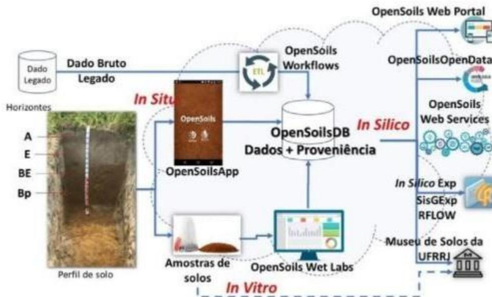
**Figura 13 – Representação conceitual dos três ambientes de coleta de dados (*in situ*, *in vitro* e *in silico*) e fluxos de dados entre os experimentos de segurança de solos e exemplos da abordagem computacional adotada pelo OpenSoils (CRUZ *et al.*, 2018)**
