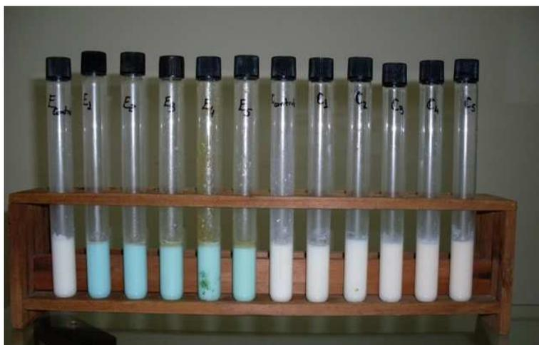
Figura 2 – Teste de Redução do Azul de Metileno 24 horas após início do teste (nos tubos E1 ao E5 não houve redução do azul de metileno).
