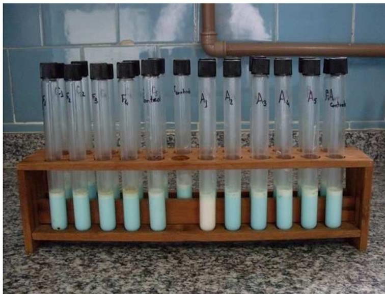
Figura 1 – Tempo de Redução do Azul de Metileno três horas após início do teste (Tubo A1 – amostra contendo 100 $\mu$ L de antimastítico A - cloxacilina) evidenciando uma amostra resistente.
