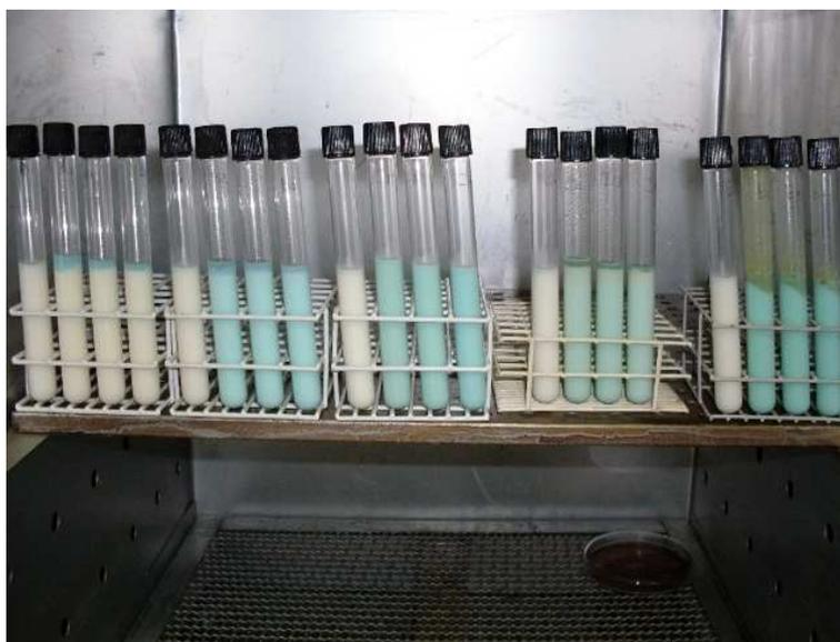
Figura 3 – Teste de Redução do Azul de Metileno duas horas após início do teste. O azul de metileno foi reduzido em todos os tubos controles e grupo com cloxacilina.
