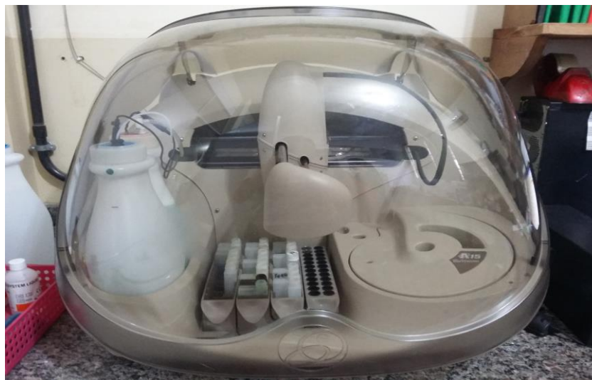
Figura 6. Analisador automatizado de acesso randômico para realização de dosagens bioquímicas e turbidimétricas, por leitura fotométrica (A15, Biosystems, Barcelona, Espanha).
