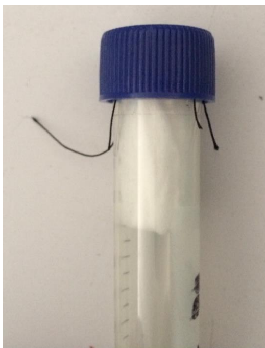
Figura 4. Algodão hidrófilo em tubo de plástico de fundo cônico, capacidade de 10 mL, mantido posicionado por fios de linha fixados externamente na tampa rosqueada.
