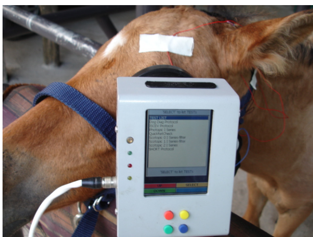
Figuras 7 e 8 – Fonte de Luz tipo LED embutida em domo. “Mini ganzfield” do HMserg- Hand Held Multi-species EletroRetinoGraph Instrument
