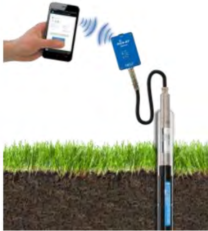
Figura B.5: TRIME-PICO IPH transmitindo dados, via bluetooth , para TRIME-PICO BT
