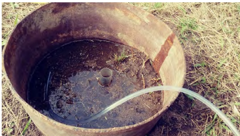
Figura B.8: Manutenção da carga hidráulica
