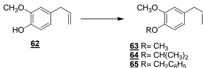
Em um balão equipado com agitador magnético, utilizou-se DMSO como solvente e 4 equivalentes de KOH pulverizado. Depois de 10 minutos de agitação, adicionou-se ao meio reacional 1 equivalente de eugenol, seguidos de 2 equivalentes do respectivo agente alquilante. O meio reacional foi mantido sob agitação, à temperatura ambiente, por aproximadamente 30 minutos.
